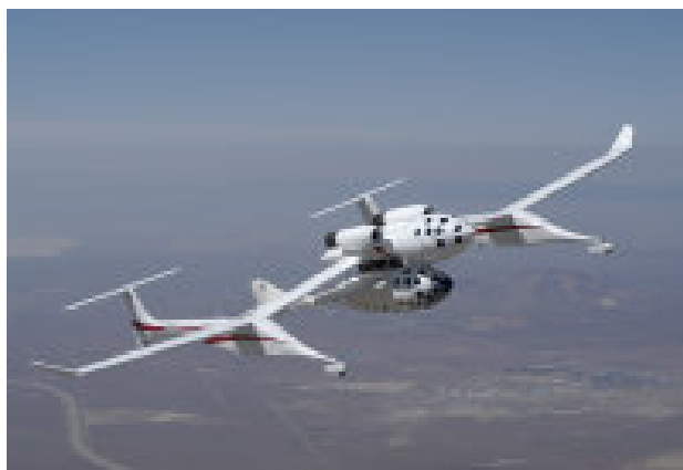
Obr. 1. SpaceShipOne, první soukromé letadlo, které uskutečnilo let na hranice atmosféry (2004). Oxid dusný byl využit jako oxidovadlo v raketovém motoru.
