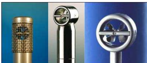
Obrázek 12 Typy vrtulkových anemometrů používaných při měření emisí
